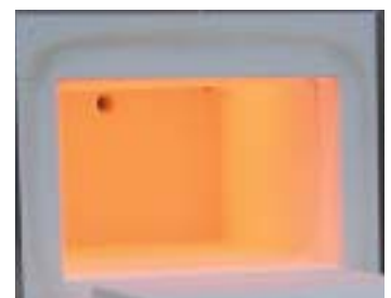
所有面加热的陶瓷马弗腔
